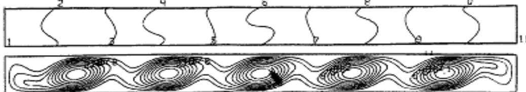
Рис. 3. Изотермы (вверху) и изолинии функции тока (внизу) при Ra=2 \cdot 10^5 , Pr=0.01 , L/H=12.71 ( T|_{y=0, y=H}=T_1+x(T_2-T_1)H/L ).
