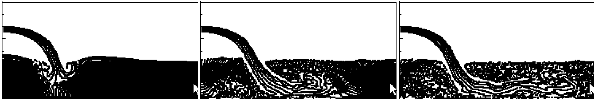
Рис. 4.6.12. Падение в водоем горизонтальной струи. Результат получен с помощью программы АСТРА.
