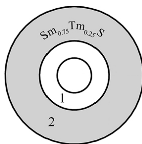
Рис. 2.34: Характер распределения коэффициента Пуассона \nu_{rz}(r) в сечении двухслойной трубки при заполнении ауксетиком \text{Sm}_{0.75}\text{Tm}_{0.25}\text{S} внешнего слоя и неауксетиками Ca, Al, Ge или W внутреннего слоя. Зона с отрицательным коэффициентом Пуассона окрашена серым.
