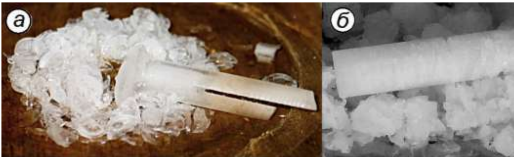
Рис. 37. Фрагменты струи: а — штифт прорезает лёд, б — лед обтекает штифт
