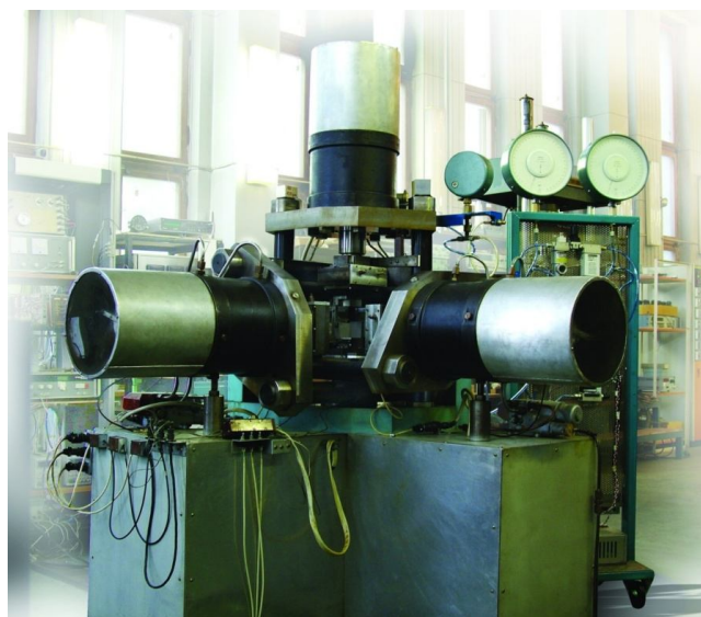
Рис.1. Испытательная система трехосного независимого нагружения.
